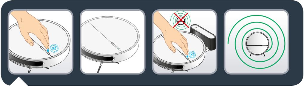
**RU** Чтобы очистить определенный участок в доме, используйте режим «Локальная уборка». Нажмите два раза на кнопку питания — робот начнет уборку, а кнопка питания будет гореть синим цветом. Обратите внимание, что режим «Локальная уборка» недоступен, когда робот находится на зарядной станции.
